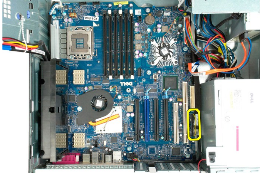
21. נתק את כבלי נתוני הכונן הקשיח והכונן האופטי מלוח המערכת.
