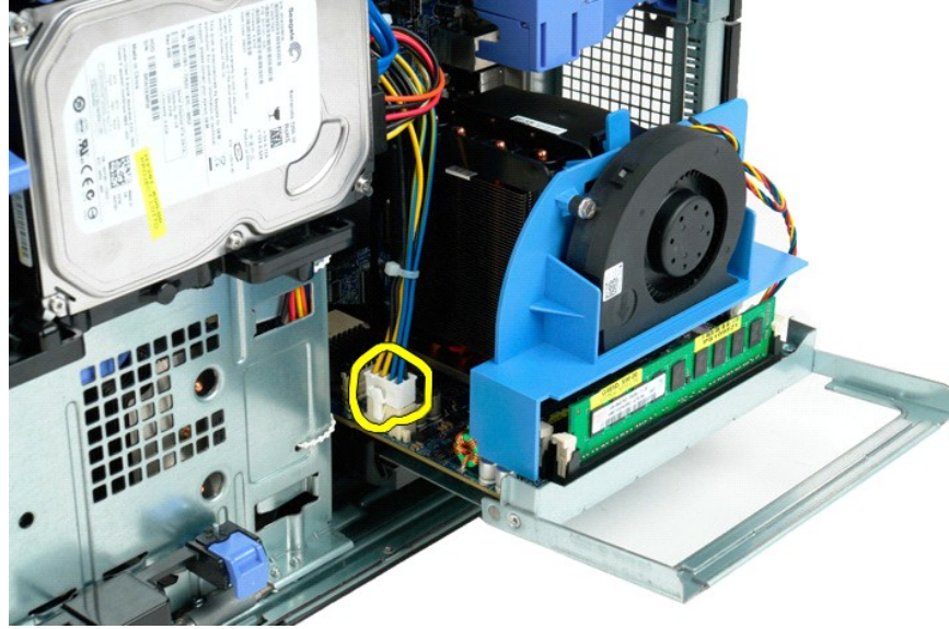
6. הסר מהמחשב את כרטיס הרחבת המעבד הכפול.
