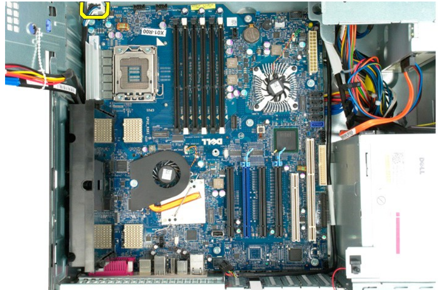
51. הסר את שלושת הברגים המאבטחים את כרטיס ההרחבה של המעבד הכפול ללוח המערכת.
